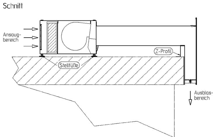
Die Luftschleieranlage wird auf den Kranz der Karusselltür aufgesetzt und mit den Stellfüßen waagrecht ausgerichtet.
