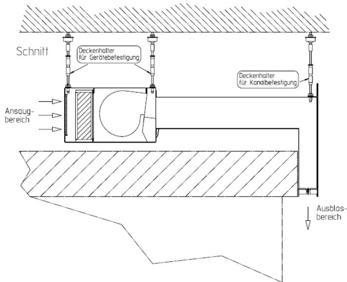
Bei der Deckenbefestigung werden mindestens 6 Spezialhalterungen (DH oder DHD, Beschreibung siehe unten) in Blind-Einnietmuttern verschraubt. Die Anzahl der benötigten Spezialhalterungen hängt von der Baulänge der Anlage ab. Die Blind-Einnietmutter befinden sich auf der Oberseite der Anlage und der Oberseite des Ausblaskanals. Die Anlage wird mit Schwerlastdübeln an der Decke über der Karusselltür befestigt. Durch Einstellen der Spannschlösser wird die Anlage waagrecht ausgerichtet.
