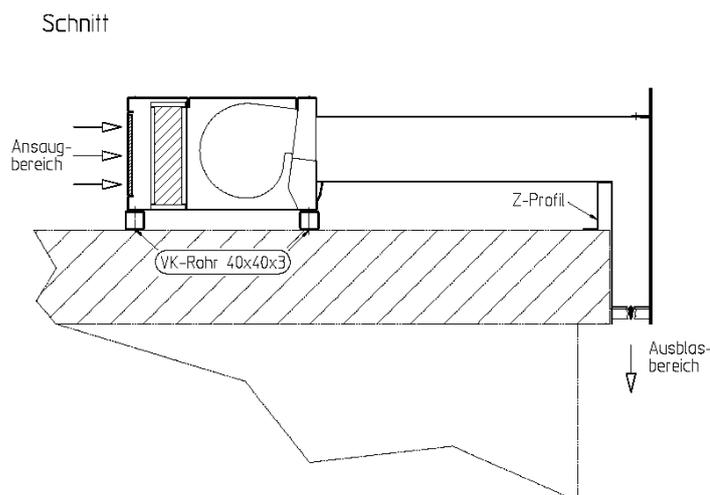
Wenn der Deckel des Kranzes das Gewicht der Luftschleieranlage nicht tragen kann, ist eine Befestigung mit Vierkantrohren sinnvoll. Bei dieser Variante lastet das gesamte Gewicht der Anlage nicht auf dem Deckel des Karusselltürkranzes, sondern wird mit Hilfe von Vierkantrohren auf die Seitenwände der Karusselltür geleitet.
