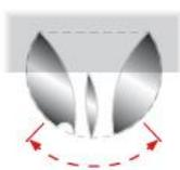
Die Luftaustrittsdüse lässt sich von Hand mittels Raster nach außen oder innen verstellen. Stellen Sie die Düse so ein, dass die Luftrichtung möglichst zur Türschwelle hin / gegen die Außenluft ausgerichtet ist.
