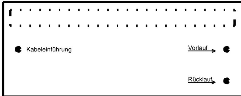
Die Heizregisteranschlüsse für Warmwasserbetrieb befinden sich auf der Anlagenoberseite. Vor- und Rücklauf sind gekennzeichnet. Ebenfalls auf der Anlagenoberseite sind Kabeleinführungen für den elektrischen Anschluss der Motoren. Bei Anlagen mit Elektro-Heizregister ist auf der Anlagenoberseite die Kabeleinführung für den elektrischen Anschluss des Heizregisters. Andere Anschlussmöglichkeiten sind auf Wunsch möglich.
